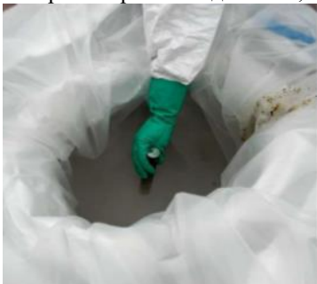
4. Измерване на концентрацията на CO2. Тя трябва да бъде около 70 % (или остатъчно ниво на кислород около 6.3%) на около 20 см от отвора на чантата. Измерването може да стане със запалена цигара, която при достигане на необходимата концентрация изгаря.
